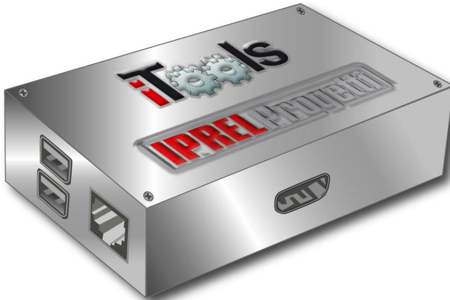
*Come si vede dall'immagine a lato, la single-board selezionata da Iprel Progetti e su cui è installato il framework ITools® dispone un processore ARM installato su una scheda corredata di una porta ethernet, due porte USB, un'uscita video HDMI ed un'uscita audio.*
